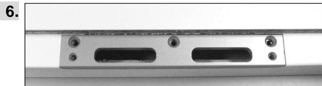
Nun das Schließblech auflegen. Es muss wieder überall dicht an den Fräskanten anliegen. Ggf. die Verschraubung korrigieren.
