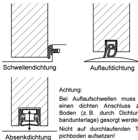
**Bild 10** Abdichtungsmöglichkeiten zwischen Tür und Fußboden
