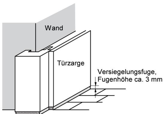
**Bild 5** Untere Anschlussausbildung bei einer Holzzarge mit Abdichtung
