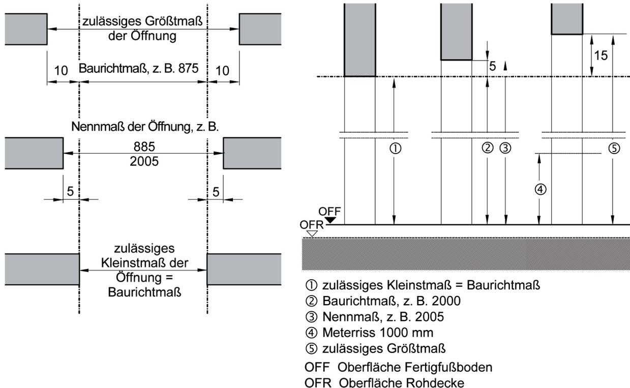
**Bild 4** Maßtoleranzen bei Wandöffnungen in der Breite (Breitenmaße) und in der Höhe (Höhenmaße) nach DIN 18100
