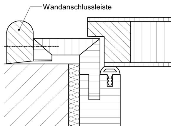
Bild 3 Zargenanschluss mit Zierleiste
